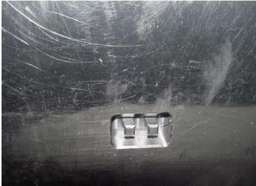
Abbildung 2: herausgearbeitete Proben ca. 5 x 5 x 15 mm
