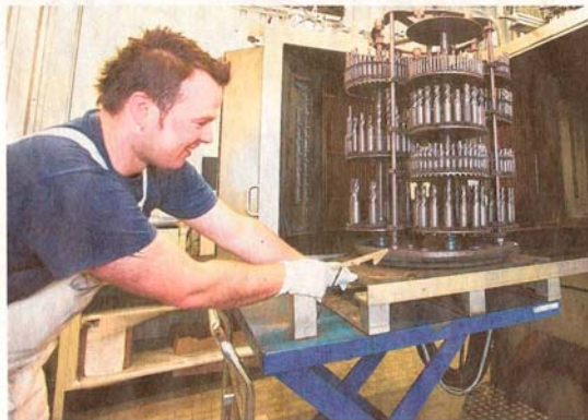
Anlagentechniker Alexander Focke holt veredelte Werkstücke aus der Beschichtungsanlage. Foto: Mario Jahn
