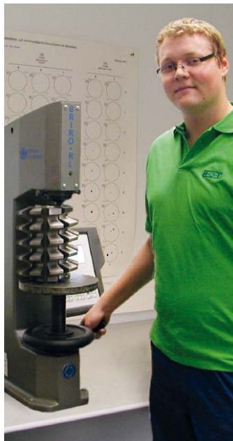
Christoph Thalheim bei der Härteprüfung eines Wälzfräasers. Die Arbeit im Prüflabor ist nur eine Facette seiner Ausbildung zum Werkstoffprüfer bei H-O-T in Schmölln.
